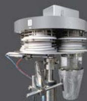
Volumetric Filler FVT100(max 100cc) FVT 200(max 200cc)
